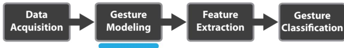
Durant l'étape de modélisation, le système construit à partir des données acquises une représentation des éléments constitutifs du geste, e.g. le système va détecter les mains. Cette étape doit :
